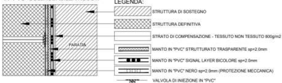
STRATIGRAFIA TIPO (B) - IMPERMEABILIZZAZIONE VERTICALE A DOPPIO STRATO IN "PVC" COLLAUDABILE/VACUUM
